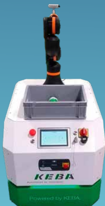
Keba Il robot acquisisce dati di navigazione attraverso QR Code
